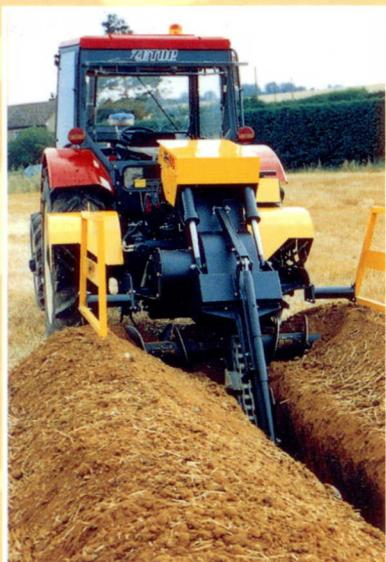
**DIE AFT 100 TRAKTOR-ANBAUFRÄSE ist eine robuste und leistungsstarke Fräse, konstruiert als Dreipunktanbaugerät für Traktoren von 90 bis 120 PS (45 - 60 kW)**
